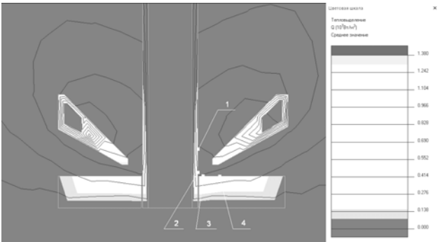
Рис. 2. Нагрев волноводной трубы и фланца. Действующее значение тепловыделения Q ( 10^7 Вт/м 3 ): 2, 3 – область пайки; 1, 4 – зоны максимального нагрева. Плотность тока в исследуемых точках : 1 – 5,2 \cdot 10^7 А/м 2 ; 2 – 4,8 \cdot 10^7 А/м 2 ; 3 – 4,7 \cdot 10^7 А/м 2 ; 4 – 5,6 \cdot 10^7 А/м 2
